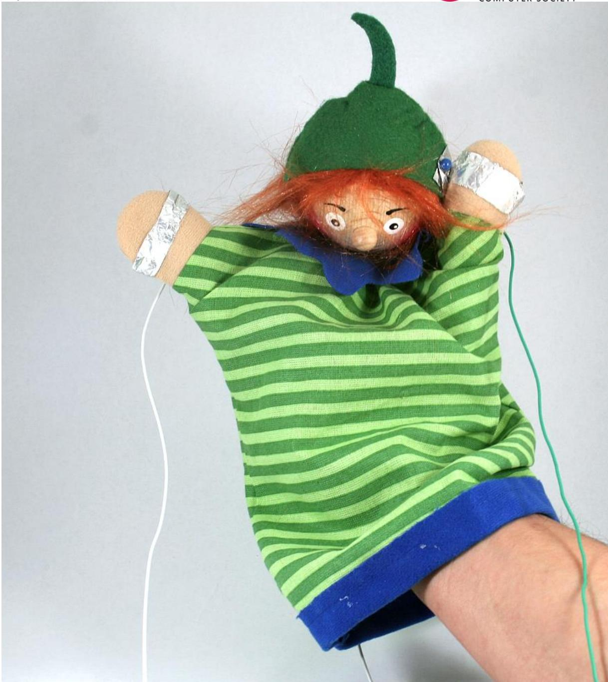
Als Ausgangspunkt könnte diese „animierte“ Elfe dienen: An den Händen und am Knopf sind leitfähige Folien angebracht, die über Kabelverbindungen mit dem MakeyMakey verbunden sind.
