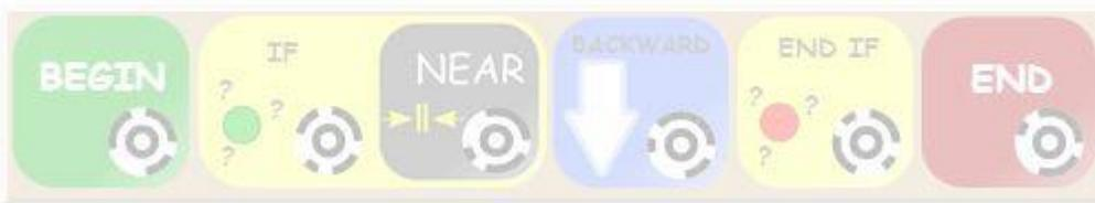
Problem: Das Programm funktioniert trotzdem nicht, sondern nur, wenn sich beim Programmaufruf ein Hindernis in der Nähe befindet. Der Befehl wird nämlich nur einmal ausgeführt.
